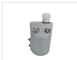
AKRON 1 60235 NEXT 2 - 3 - 4 - 6 - 8 Per montaggio di un apparecchio singolo a testa palo Ø mm 60, costituito da un blocco in lega di alluminio pressofuso, verniciato in colore Silver. Single top pole mounting support mm 60, in die cast aluminium block painted Silver.
