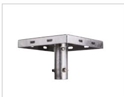
AKRON 4 60242 NEXT 2 - 3 - 4 - 6 - 8 Accessorio in acciaio zincato a caldo per montaggio n. 4 proiettori per pali Ø 76 mm max. Per NEXT 6 e NEXT 8 montaggio di soli n. 2 proiettori. Hot deep galvanized sheet steel accessory for max 4 floodlights, for pole max Ø 76 mm. For NEXT 6 and NEXT 8 only n. 2 floodlights.
