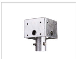
AKRON 5 60246 NEXT 2 - 3 - 4 - 6 - 8 Accessorio in acciaio zincato a caldo per montaggio n. 2/4 sbracci cod. 60612-60613-60614-60615 per pali Ø 76 mm max. Hot deep galvanized sheet steel accessory for num. 2/4 extension arms code 60612-60613-60614-60615 for Ø 76 mm pole.
